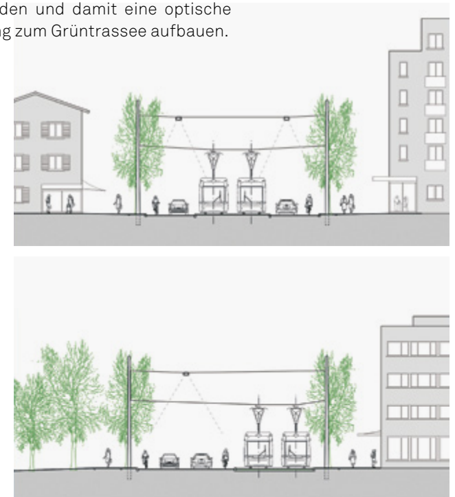
Fahrleitungsmasten in der Baumschicht: Mittellage (oben) und Seitenlage
